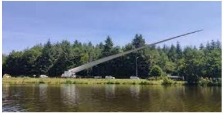
*Illustration d'un « blade lifter » permettant l'acheminement des pales d'éolienne (source : TotalEnergies Renouvelables France)*
